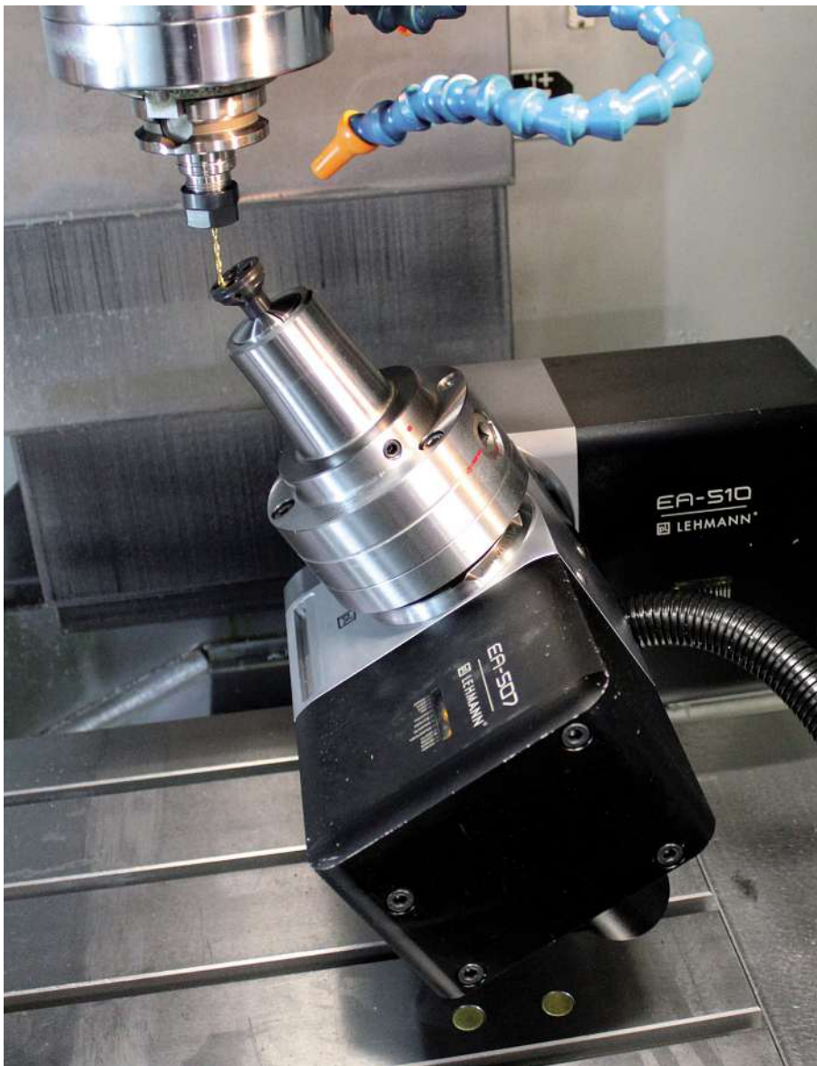
Der Zwei-Achsen-Drehtisch TF-507510.RR fix von pL Lehmann macht aus einem dreiachsigen Bearbeitungszentrum eine produktive 5-Achs-Maschine.
