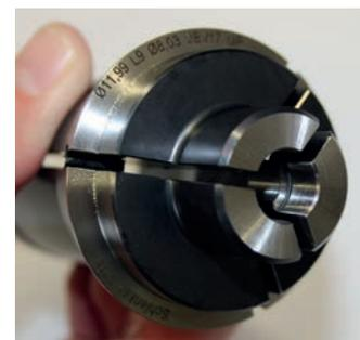
Im Detail die zweifache Spannaufnahme über die beiden verschiedenen (8 und 12 mm) Innendurchmesser der neuen Spannzange.
